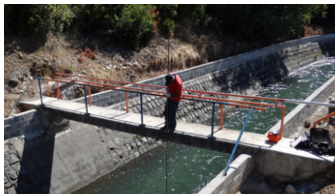
Aforos en Alimentador Digua.
